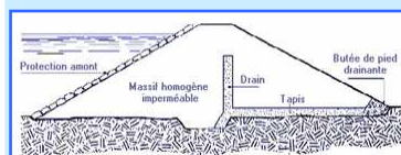
Le barrage en remblai
